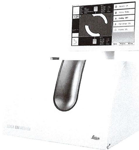
该离子减薄仪的离子枪为鞍形场散焦离子枪，离子束流密度较小（8 kV/3 mA 条件下约为 1 mA/cm<sup>2</sup>），这虽然可以减小减薄过程中对样品的损伤，但影响减薄速率。此外，该离子减薄仪的离子束能量下限为 0.8 keV，不利于样品的大面积均匀厚度薄区的获得。该仪器的特点是具有 ±90° 的减薄角度范围，但过高的减薄角会导致样品损伤，故实用意义不太大。
