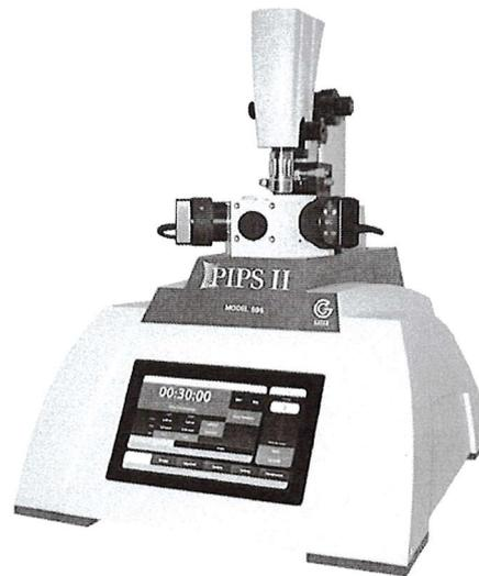
该离子减薄仪的离子枪在低能范围内具有优异的聚焦能力，可以在减少样品损伤的同时提高减薄效率，提高样品质量。同时，这种改良的低能量离子束还可用于 FIB 样品的表面清洁。此外，该设备搭载 WhisperLok 系统及 X-Y 可调控样品台，可对样品中某些感兴趣的区域进行对中重复减薄，以获得利于高分辨拍摄和分析的区域。
